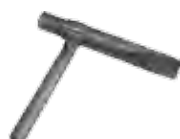
Приспособление НСВ к разжиму большому (РСВ1) для страгивания вагонов
