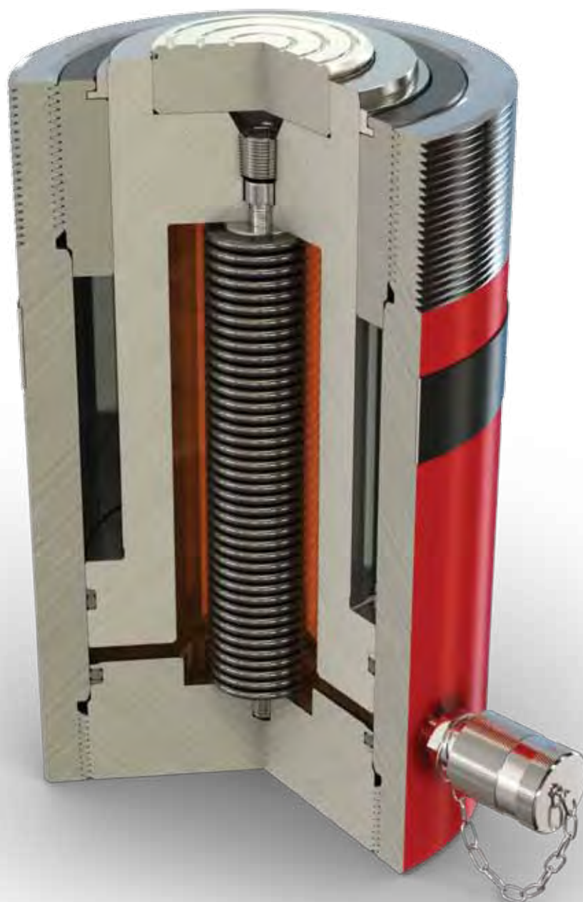
Домкрат с пружинным возвратом поршня
