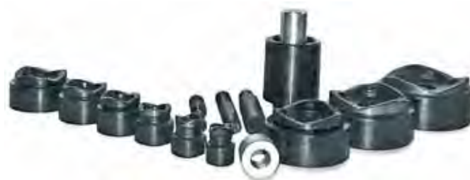
ППЛ15 с комплектом матриц и пуансонов
